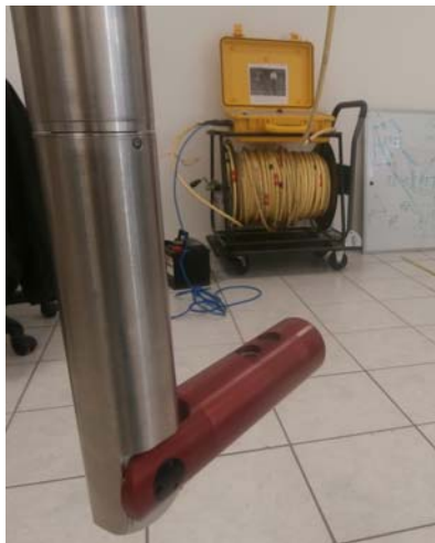
Bras laser déplié en position de mesure
