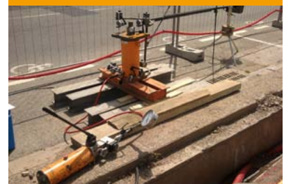
→ Essai de contrôle sur micropieu
