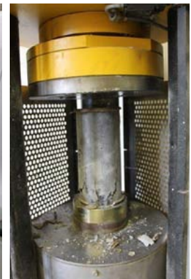
→ Essai de résistance en compression sur éprouvette de béton
