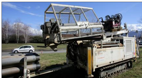
Ici, une équipe de Fondasol intervenant avec une foreuse pneumatique, qui fait des forages pressiométriques. Au total, environ 20 forages différents ont ainsi été réalisés au Rondeau. Photo Le DL/Jean-Benoît VIGNY
